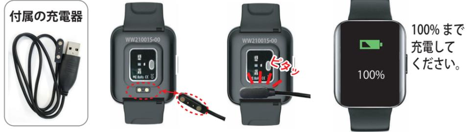
ウォッチの裏側にある 2 個の金属の丸い点と充電器の先にある丸い点とを合わせます。磁石になっているので、引き合ってピタッと合います。
